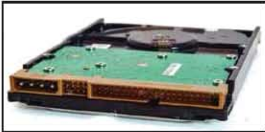
চিত্র ৩.১৭: আইডিই পোর্টের হার্ড ডিস্ক (পাটা)
